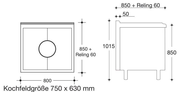
**Glühplattenherd mit hohem Abgaskamin 165 mm !**
