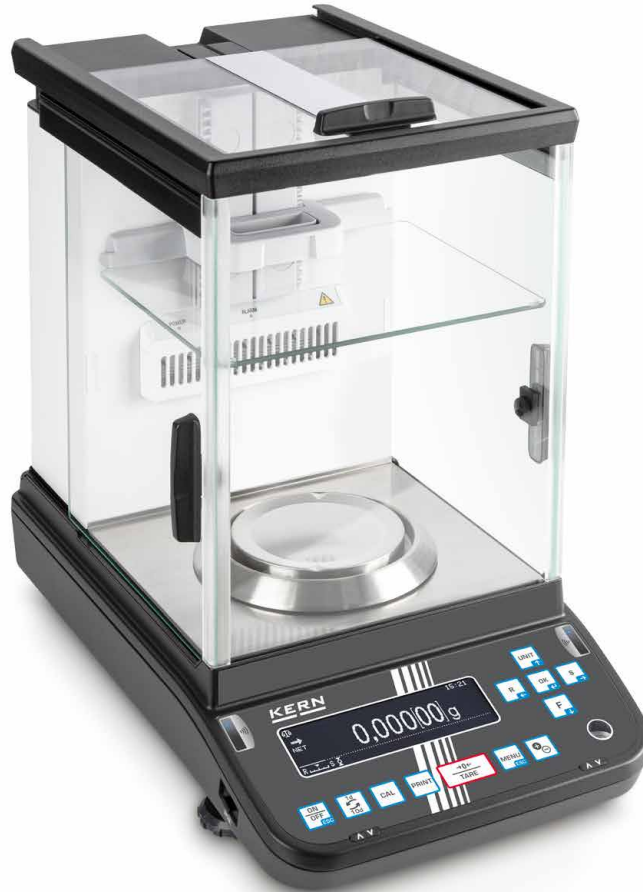
KERN ABP-A mit integriertem Ionisator und internem Windschutz
