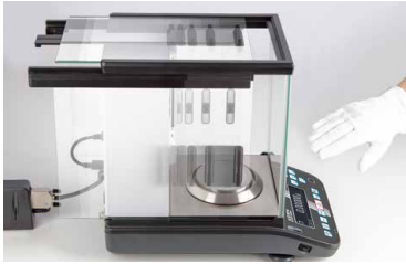
Automatische Schiebetüren – mit Hilfe von Sensoren steuerbar
